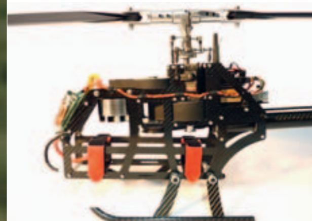
In der Seitenansicht wird der konstruktive Aufbau mit dem zweistufigen Zahnriemengetriebe deutlich. Markant ist der breite Riemen der zweiten Stufe, der dem hohem Drehmoment in Verbindung mit 16s-LiPo-Power gerecht wird
