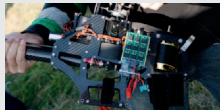
Rechte Chassisseite mit dem Federdämpfersystem für den Heckriemen.
